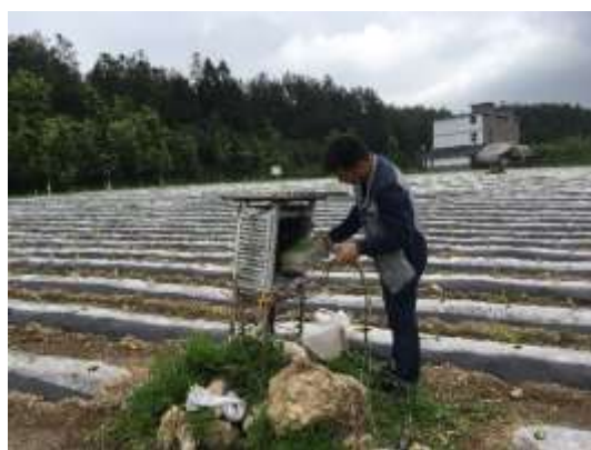
图 9、10 彭水驻点人员安装土壤温湿度监测仪
